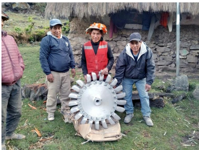
Die Pelton-Turbine mit den Laufradschaufeln wandelt die Bewegungsenergie des Wassers in Strom um.
