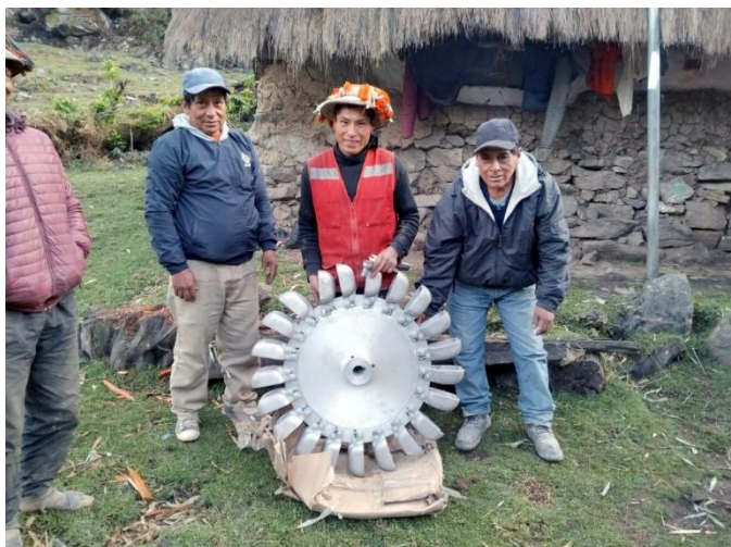
La turbina Pelton con álabes impulsores convierte la energía cinética del agua en electricidad.
